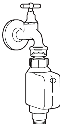
tuyau d'arrivée d'eau de sécurité
