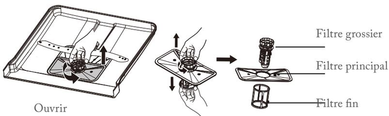
Tenez le filtre grossier et tournez-le dans le sens inverse des aiguilles d'une montre pour déverrouiller le filtre. Soulevez le filtre et retirez-le du lave-vaisselle.
