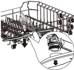
Pour démonter le bras de lavage supérieur, immobilisez l'écrou situé au centre et tournez le bras dans le sens inverse des aiguilles d'une montre pour le retirer.
