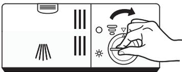
3. Fermez le bouchon du réservoir de liquide de rinçage en le tournant dans le sens des aiguilles d'une montre.
