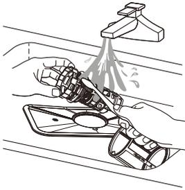
Des résidus d'aliments plus gros peuvent être nettoyés en rinçant le filtre sous l'eau du robinet.
