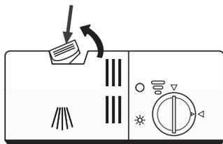
1. Appuyez sur le loquet de dégagement du distributeur de détergent pour ouvrir le couvercle.
