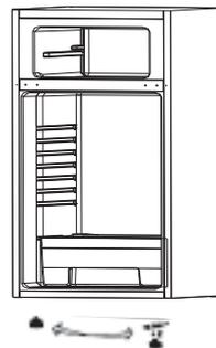
5. Retirez la goupille de la charnière qui se trouve dans le bas des portes du réfrigérateur et du compartiment de congélation. Insérez la goupille de la charnière de remplacement qui est fourni avec l'appareil à l'autre côté de la porte.
