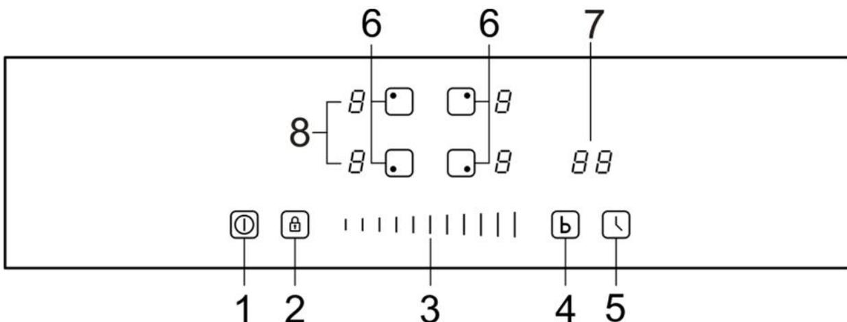
1. Bouton de MARCHE/ARRÊT 2. Bouton de verrouillage 3. Curseur tactile de Puissance 4. Bouton « Boost » 5. Bouton de minuteur 6. Bouton de sélection des foyers 7. Affichage de minuteur. 8. Fonction de zone flexible
