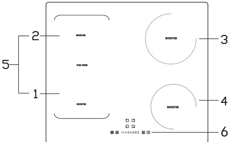
1. Zone de cuisson 2100W max. 2. Zone de cuisson 1500W max. 3. Zone de cuisson 2100W max. 4. Zone de cuisson 1500W max. 5. Zone de cuisson 3000W max. 6. Panneau de commande.
