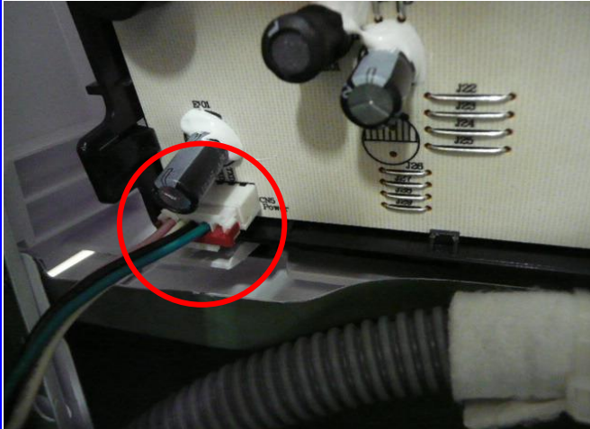
Vérification filerie entre platine d'affichage et platine de puissance
