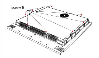
Step2: remove the screw B
