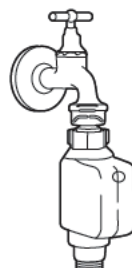
Tuyau d'arrivée d'eau de sécurité
