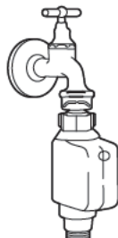
tubo de suministro de seguridad
