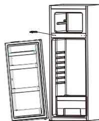
7. Placez la porte du réfrigérateur sur la charnière du milieu, en vous assurant que la goupille de charnière est insérée dans le trou au bas de la porte du réfrigérateur. Ensuite, placez la charnière supérieure, vissez la porte et vissez le boulon, recouvrez le couvercle de charnière gauche et vissez le boulon.
