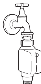
Tuyau d'arrivée d'eau de sécurité
