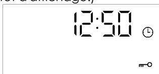
Image 8: effet d'affichage activé par le verrouillage de la porte en mode veille
