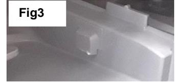
Leur rôle principal est en cas de débordement, suite à une anomalie de vidange ou de prise d'eau trop importants, d'acheminer l'eau vers le flotteur situé sous l'appareil (fig 4 et 5)
