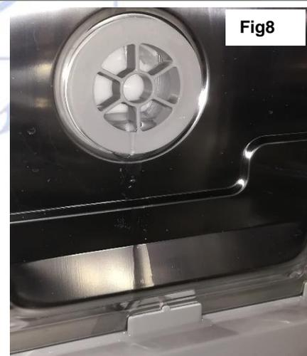
L'écoulement vers le socle peut être dû à des éclaboussures au niveau "bouchons de trop plein". Ces éclaboussures peuvent provenir d'une vague créée lors de la rotation des bras.
