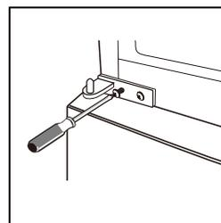
10. Dévissez la butée centrale droite du bas de la porte supérieure, puis installez la butée centrale gauche sur le côté gauche du bas de la porte supérieure.
