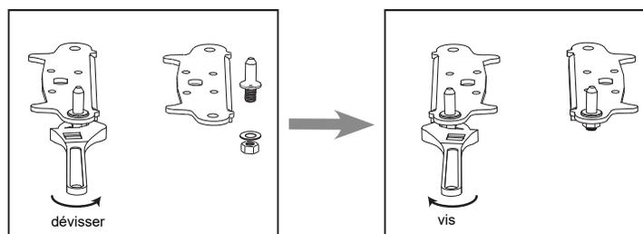
8. Remettez en place le support fixant l'axe de charnière inférieur, remplacez les deux pieds réglables. Transférez la porte inférieure en position propriété.
