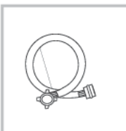
Tuyau d'arrivée d'eau froide
