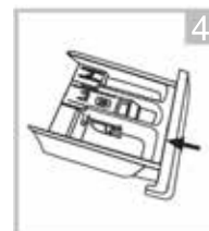
Insérer à fond le bac séché au préalable dans le conduit
