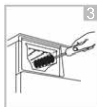
Nettoyer le conduit d'insertion du bac avec une brosse souple
