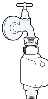
tubo de suministro de seguridad
