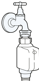
Tuyau d'alimentation de sécurité
