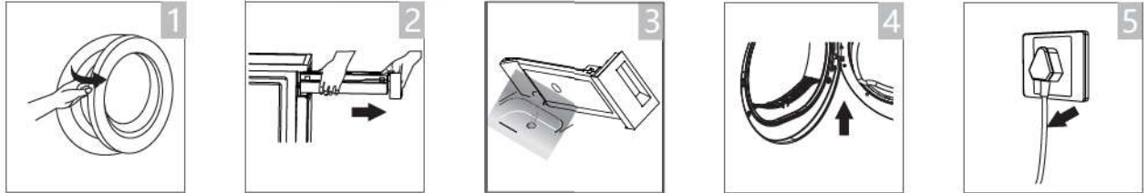
Abra a porta e retire a roupa do tambor. Retire o recipiente da água. Verta a água de condensação. Limpe o filtro de algodão. Desligue a máquina de secar da alimentação elétrica.
