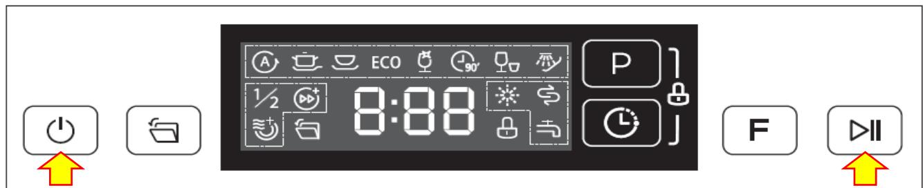
Aby uzyskać dostęp do programu testowego, należy odłączyć i ponownie podłączyć zmywarkę
