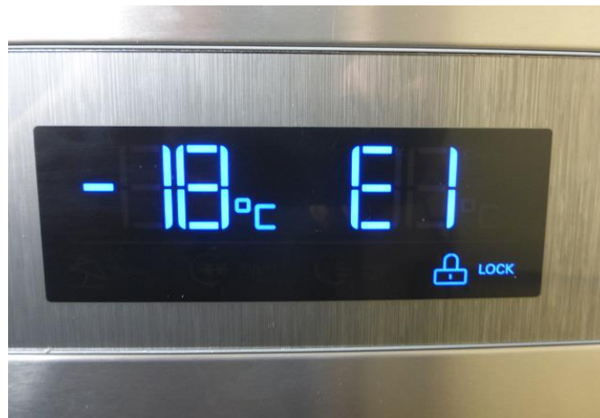
E1 :Sonde réfrigérateur coupée ou en court-circuit
