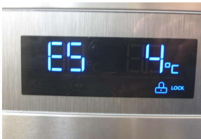
E5 :Sonde évaporateur coupée ou en court-circuit
