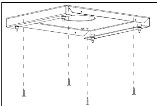
3. Assemblez la plaque décorative avec la plaque de suspension avec des vis, 8 x ST4\*8 mm
