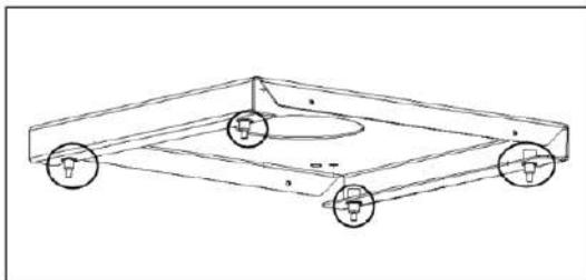
2. Positionner la plaque de suspension au plafond et marquer la position des trous avant perçage.
