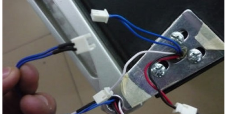
Puis déconnecter les fils bleus reliant la sonde à la platine d'affichage.
