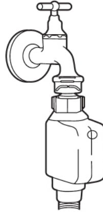
tuyau d'arrivée d'eau de sécurité
