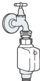
tubo de suministro de seguridad
