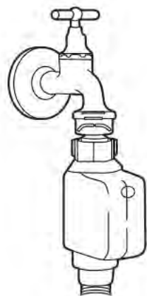
tuyau d'arrivée d'eau de sécurité
