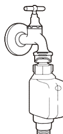
tuyau d'arrivée d'eau de sécurité
