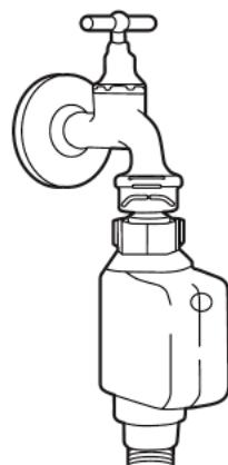
tuyau d'arrivée d'eau de sécurité
