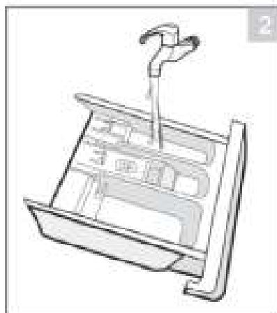
Nettoyez le tiroir distributeur et le couvercle de l'adoucisseur sous l'eau
