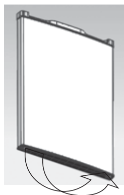
Réinstallez la butée et le coussinet de la porte.
