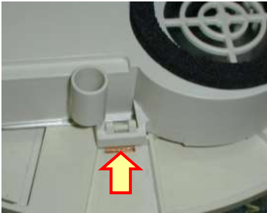
Débloquer l'ergot de fixation sous l'inducteur
