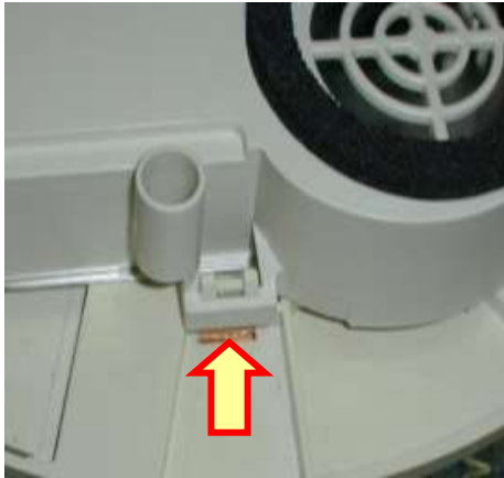
Débloquer l'ergot de fixation sous l'inducteur
