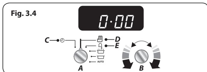
L'horloge doit être réglée sur l'heure actuelle pour que les fours puissent fonctionner.
