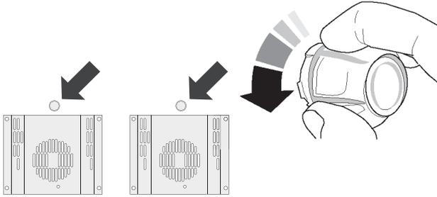
Retirez le couvercle de l'ampoule en tournant d'un quart de tour dans le sens inverse des aiguilles d'une montre. Cela peut s'avérer difficile (**Fig. 7.2**).
