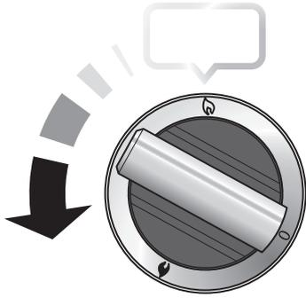
Le dispositif d'allumage produit une étincelle et allume le gaz. Continuez d'appuyer sur le bouton pendant quelques secondes pour permettre l'arrivée du gaz dans le brûleur (10 secondes).
