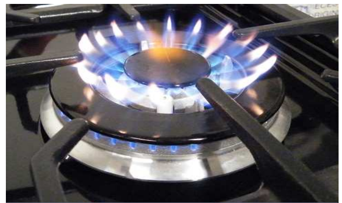
Montage injecteurs inversés : Aspect anormal de flammes à plein débit
