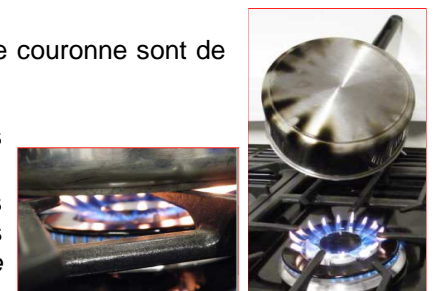
Montage injecteurs inversés : Aspect anormal de flammes à plein débit
