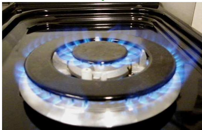
Montage correct : Aspect normal de flammes à plein débit
