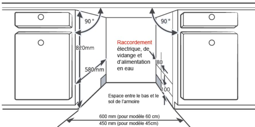
2. Si le lave-vaisselle est **installé** dans le coin de l'armoire, un certain espace est nécessaire lorsque la porte est ouverte.
