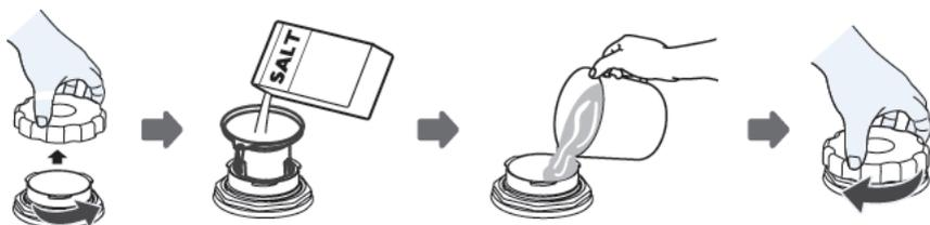
1. Retirez le panier inférieur et dévissez le bouchon du réservoir.
