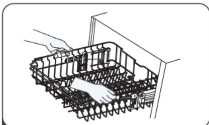
**1** Pour relever le panier supérieur, il suffit de soulever le panier supérieur au centre de chaque côté jusqu'à ce que le panier se verrouille en place en position haute. Il n'est pas nécessaire de soulever la poignée de réglage.
